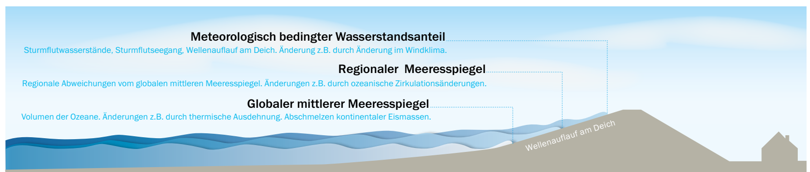
Abb. 3: Schematische Darstellung der Faktoren, die Sturmflutwasserstände ändern können. Änderungen im globalen und regionalen Meeresspiegel beeinflussen sowohl die mittleren als auch die Sturmflutwasserstände. Änderungen im Windklima und Wellenauflauf sind nur für die Sturmflutwasserstände von Bedeutung. Zusätzlich zu den dargestellten Faktoren spielen gezeitenbedingte Änderungen eine Rolle (NORDEUTSCHES KLIMABÜRO 2009)
