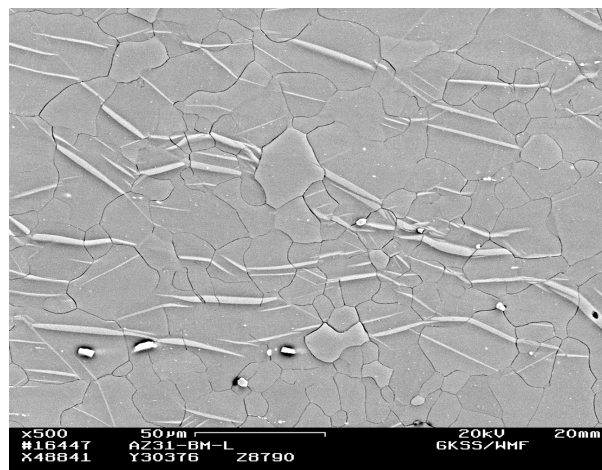
Bild 2.2: Grundwerkstoff AZ31-HP, Kernbereich, Gefüge in Walzrichtung. Figure 2.2: Base material of AZ31-HP in the core region, viewing direction is parallel to rolling direction.
