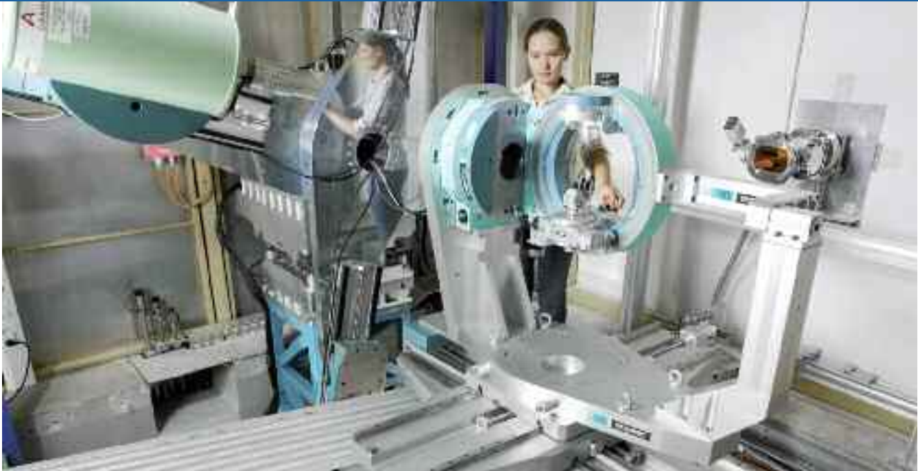
DAS MATERIALFORSCHUNGSDIFFRAKTOMETRER IST WEGEN SEINER GRÖÖE IN EINER GRUBE MIT 1,5 M TIEFE AUFGEBAUT. IN DER HIER GEZEIGTEN KONFIGURATION BILDET EINE EULERWIEGE DEN PROBENORT. SIE IST IN EINEM SPEZIELLEN RAHMEN MONTIERT UND KANN DAHER SOWOHL FÜR HORIZONTALLE ALS AUCH VERTIKALE BEUGUNG GENUTZT WERDEN. ON ACCOUNT OF ITS SIZE, THE DIFFRACTOMETER – USED FOR MATERIALS RESEARCH – IS INSTALLED IN A PIT 1.5 METRES IN DEPTH. IN THE CONFIGURATION SHOWN, THE SPECIMEN IS PLACED IN AN EULERIAN CRADLE, WHICH IS MOUNTED IN A SPECIAL FRAME SO AS TO PERMIT THE USE OF BOTH HORIZONTAL AND VERTICAL DIFFRACTION.
