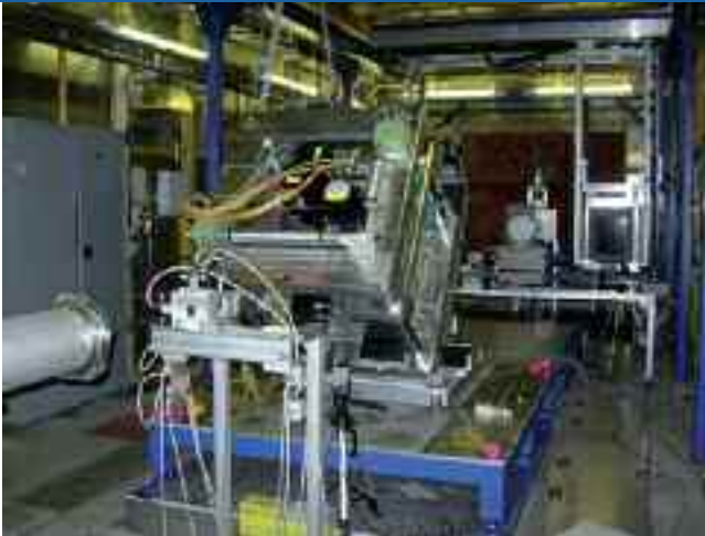
DIE IN-SITU REIBRÜHR-SCHWEIßAPPARATUR "FLEXI-STIR" WIRD AM HARWI II GETESTET. DER MONOCHROMATISCHE STRAHL KOMMT VON LINKS DURCH DAS STRAHLROHR, DESSEN ENDE NOCH IM BILD ERKENNBAR IST. IM HINTERGRUND RECHTS SIND DER MAR555- UND EIN MAR345-DETEKTOR AUFGEBAUT. THE ONSITE FRICTION STIR WELDING MACHINE "FLEXI-STIR" UNDERGOES TESTS AT HARWI II. THE MONOCHROMATIC BEAM ENTERS VIA A BEAM PIPE, THE END OF WHICH IS JUST VISIBLE ON THE LEFT OF THE PICTURE. THE MAR555 AND A MAR345 DETECTOR ARE MOUNTED IN THE BACKGROUND TO THE RIGHT.
