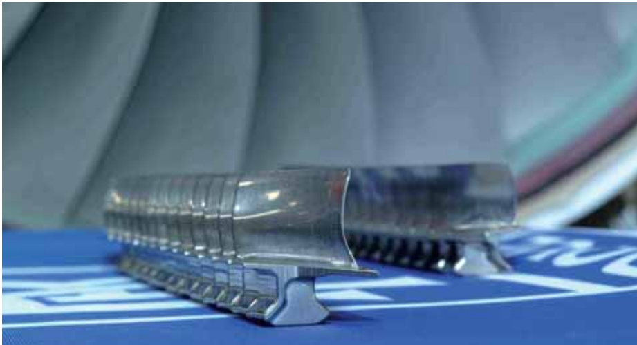
Kompressor-Laufschaufeln für ein Flugtriebwerk aus einer von GKSS patentierten TiAl-Legierung, die in einem gemeinsamen Forschungsvorhaben durch Strangpressen, Schmieden und elektrochemisches Senken hergestellt wurde.
