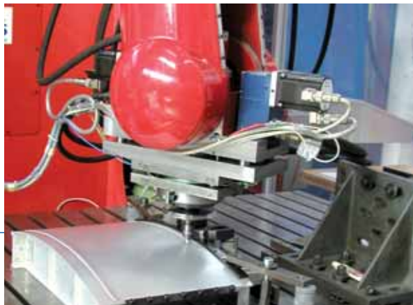
Kraftgesteuertes Reibrührschweißen einer gekrümmten Flugzeugschale mit einem Tricept TR805 Roboter.
