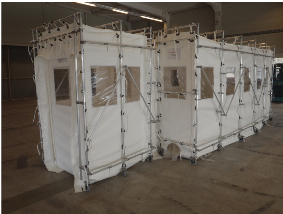
Abbildung 4-17: Mobiles Arbeits- und Dekontaminationszelt mit Zugangsschleuse
