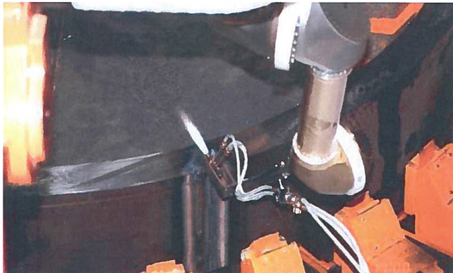
Abbildung 4-7: Autogen-Brennschneidmodul am Verpackungsmanipulator
