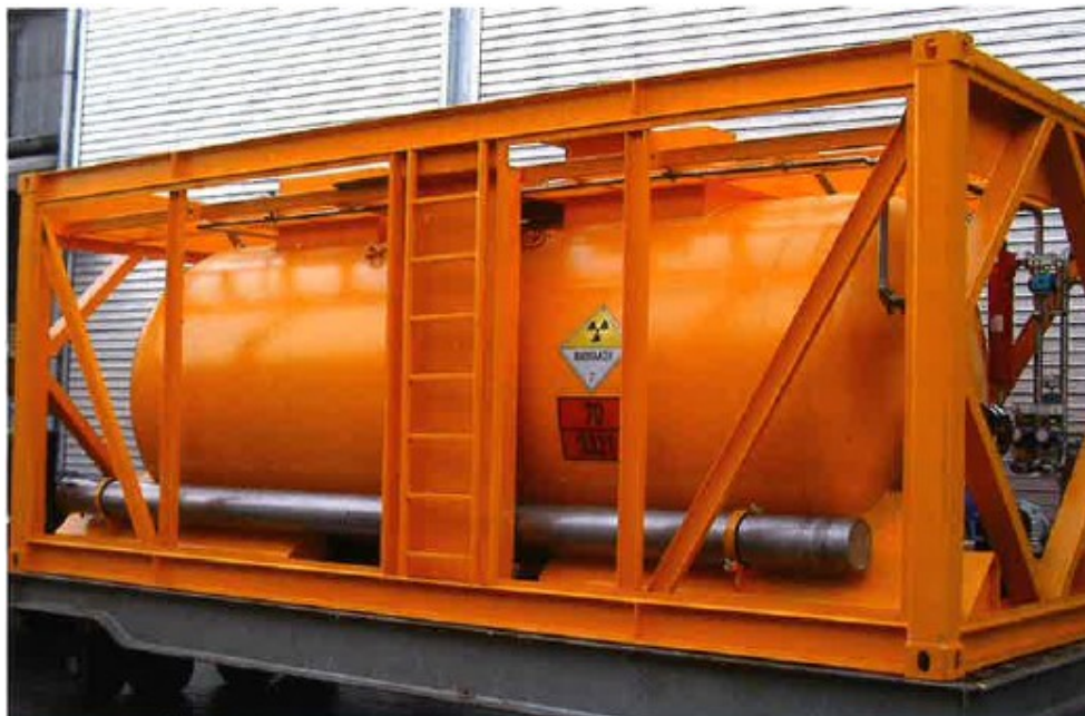
Abbildung 4-18: Tank-Container für flüssige radioaktive Stoffe (LSA II) /15/
