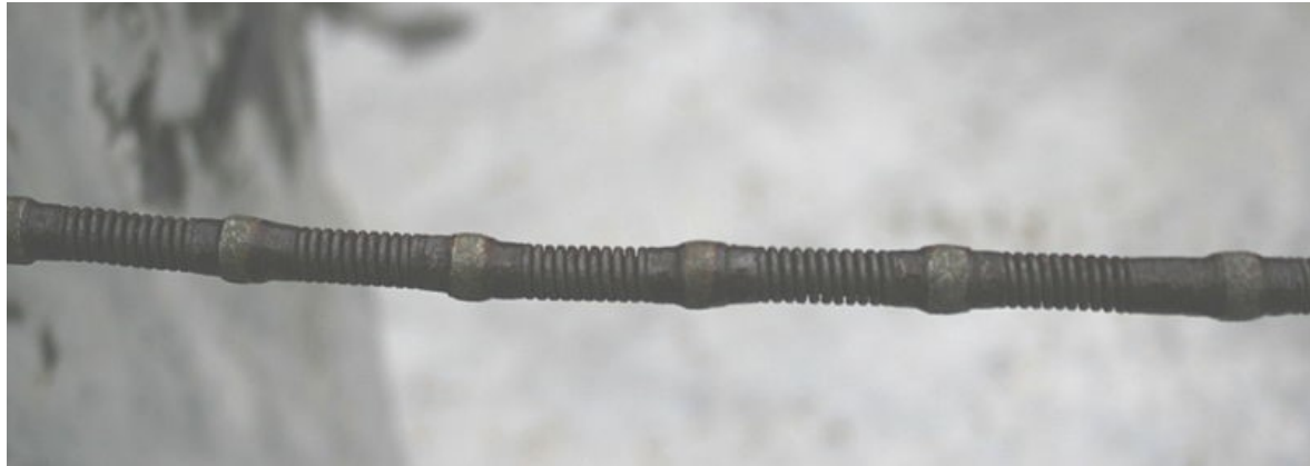
Abbildung 4-9: Seil einer Seilsäge /12/
